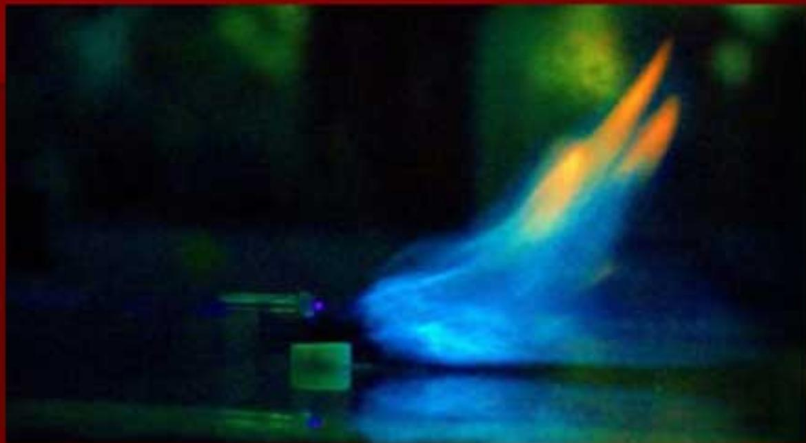
Principiul de functionare- Cimpul electric oscilant imprimă o miscare rapidă asupra particulelor încărcate electric din flacără. Particulele în miscare antrenăază în miscare componentele plasmatice ale flacării îndepărând-o pe aceasta de materialul combustibil
